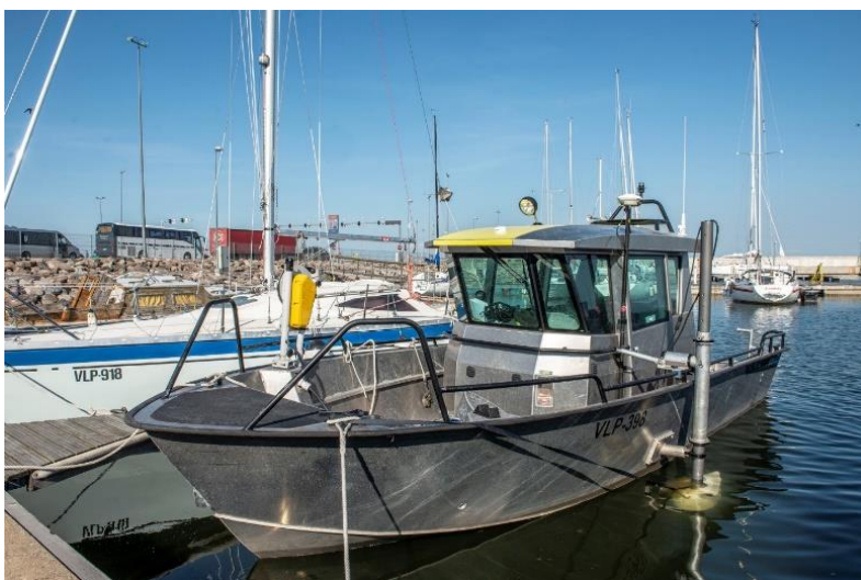
Joonis 9. EGT uurimispaa di ja setteprofiilaatori Chirp kiirgur-vastuvõtja uurimislava poordi külge kinnitatuna.
