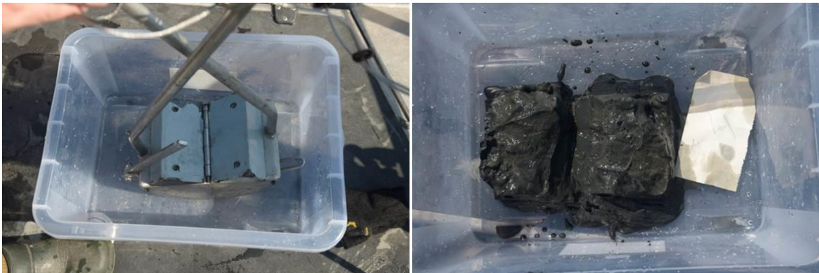
Joonis 17. Sette pinnaproovide võtmine Van-Veen tüüpi haardkopaga.
