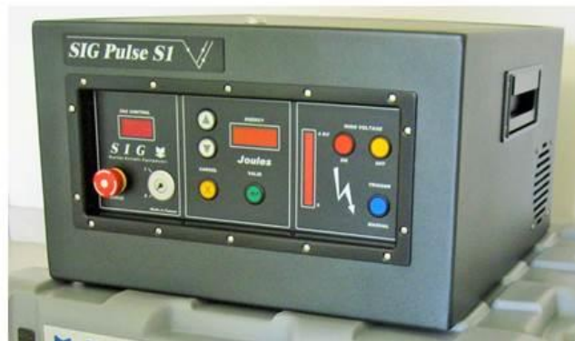
Joonis 15. Madalasagedusliku Boomer -tüüpi setteprofiilaatori pukseeritav katamaraan ja selle alla kinnitatud metallplaatidest seisreaktiivse signaali tekitav kiirgur-saatja (vasakul) ning süsteemi kontrollseade (paremal).
