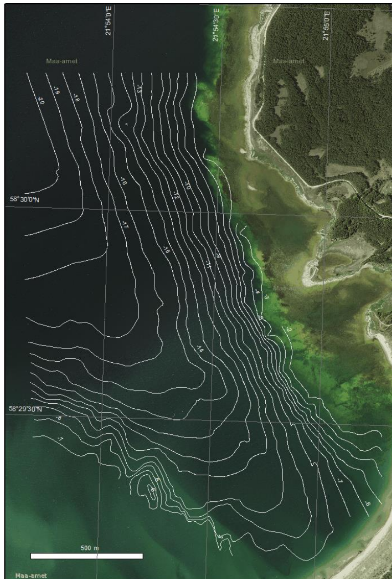
Joonis 21. Pingeri profileerimise andmetele tuginev Uudepanga lahe veealuse rannanõlva batümeetria kaart. Alus Maa-ameti ortofoto.
