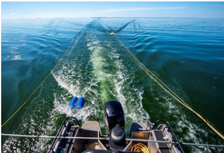
Joonis 8. Kõrgesageduslik kajalood ( Pinger ) pukseerituna siniste poide külge kinnitatuna (uurimispaa di ahtrist vasakul). Madalasageduslik setteprofiilaator ( Boomer ) (valged poid taamal paremal) ja selle vastuvõtja hüdrofon (vasakul) 20 meetri kaugusel ahtrist.
