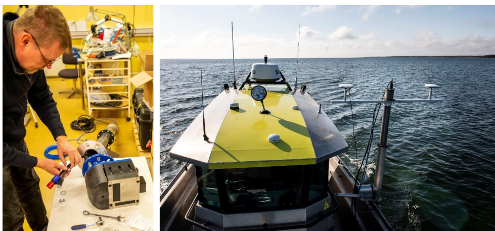
Joonis 13. Lehviksonari anduri monteerimine (vasakul) ja lehviksonariga mõõdistamine paadipoordi kinnitatult (paremal).
