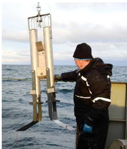
Joonis 18. Setteproovide võtmine Gemax-tüüpi proovivõtuseadmega.
