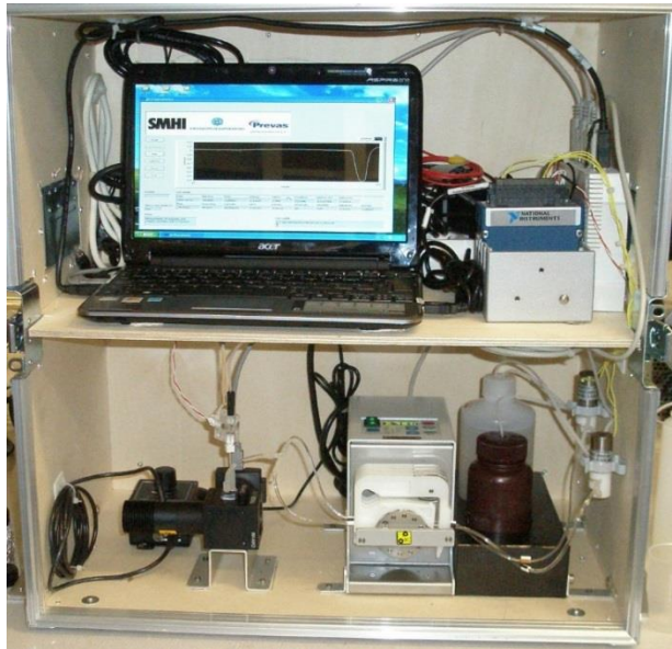
Joonis 3.4.3.3.1 Salmexi läbivoolusüsteemiga ühendatud pH mõõteseade.
