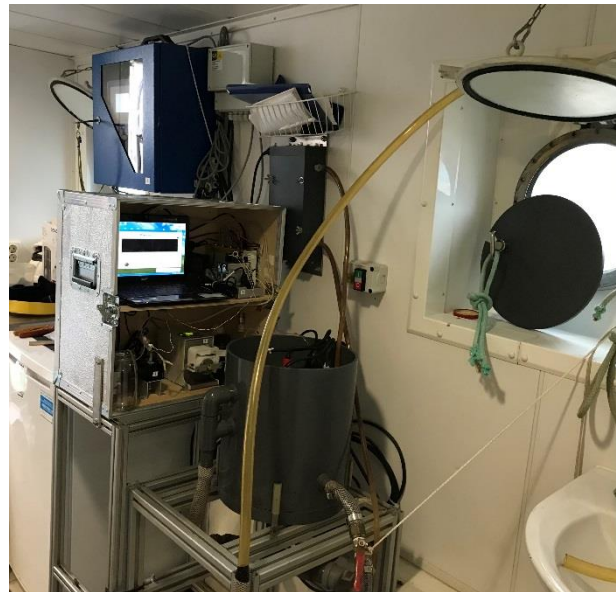
Joonis 3.4.3.3.1 Salmexi läbivoolusüsteemiga ühendatud pH mõõteseade.
